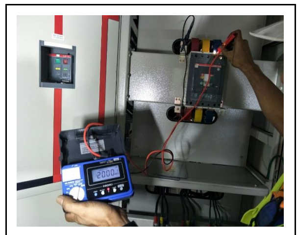
ภาพขณะทำการ INSULATION RESISTANCE TEST
